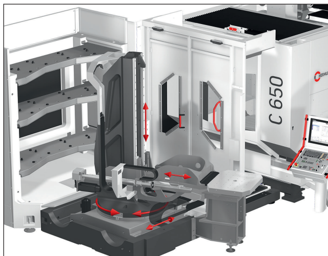
2 Handlingsystem HS flex heavy adaptiert an ein 5-Achs-Bearbeitungszentrum C 650 im Schnittbild
